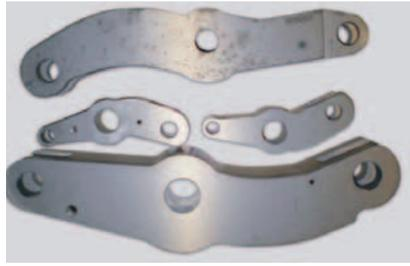
Das fleckige Bauteil oben wurde rein per Lösemittel gereinigt, die Teile in der Mitte und unten erfuhren eine Hybrid-Reinigung.
